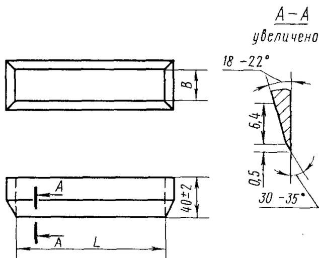
$B - (10 \pm 0,1) \text{ мм}; L - (30 \pm 0,1) \text{ мм}.$
